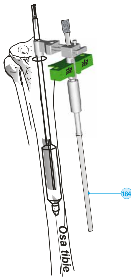
Obr. 8: Sestava intramedulárního cíliče a vodící tyče doplněná centrovací tyčí
