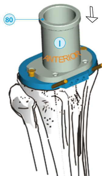
Obr. 13: Nasazení vrtacího pouzdra kuželové frézy
