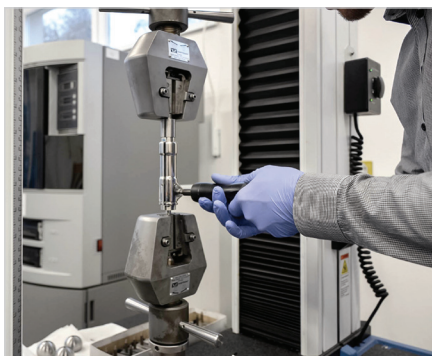
Zkouška distrakčního mechanismu, Bc. David Sitte
