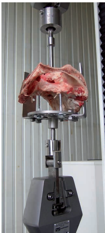
Obr. 3 Pánev fixovaná šrouby k přírubě přípravku
