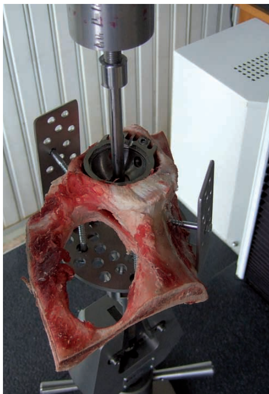
Obr. 4 Fixace TC jamky v kadaverózní pánvi – zavaděč upnutý na kyvné hlavě přípravku
